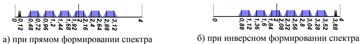
Рисунок 2.1 Распределение сигналов в режиме 6 x 200 каналов ТМ согласно R.38 ITU-T
