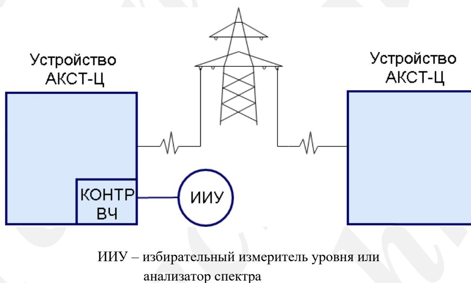
Рисунок 3.1 Схема измерения и подстройки уровней передачи
